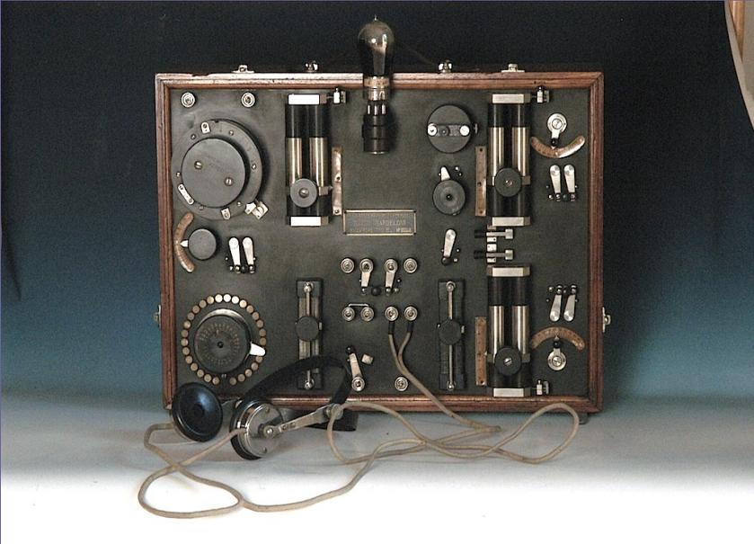
Primo ricevitore a cristallo e valvola termoionica realizzato dall'Esercito Italiano secondo i dati tecnici e gli schemi concessi da Marconi, 1915.
